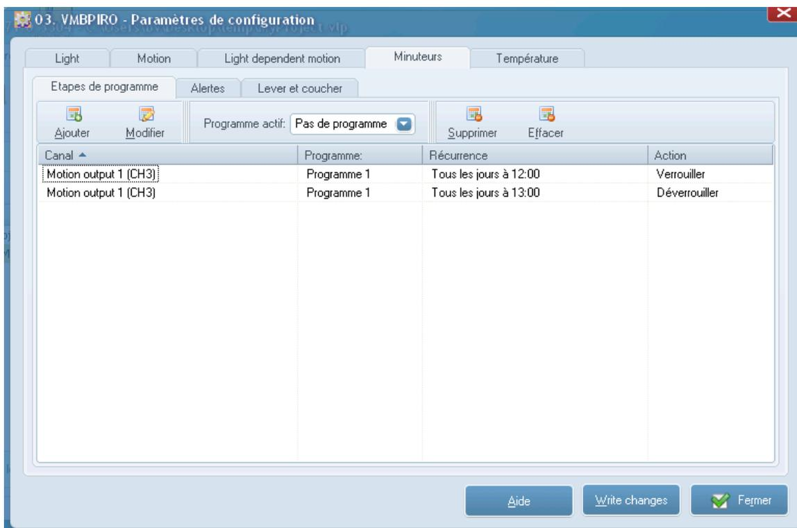
Les étapes de programmation permettent d'activer ou de désactiver la détection de mouvement, de lumière et crépusculaire à des moments spécifiques, indépendamment l'une de l'autre.
