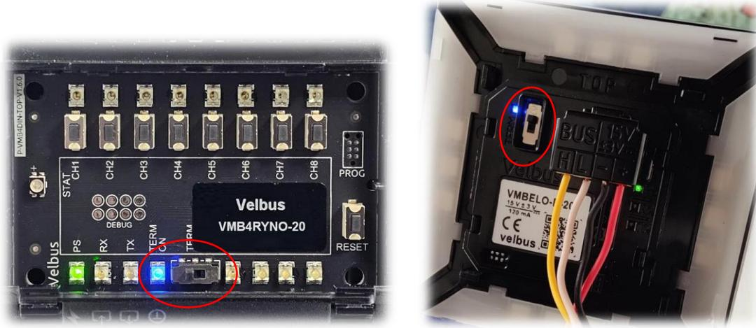
Dans cette configuration de base, fermez les terminators sur le panneau VMBELO et sur le module VMB4RYNO.
