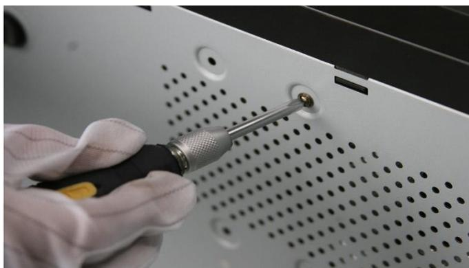
Figura 2-6 Retirar la Cubierta
