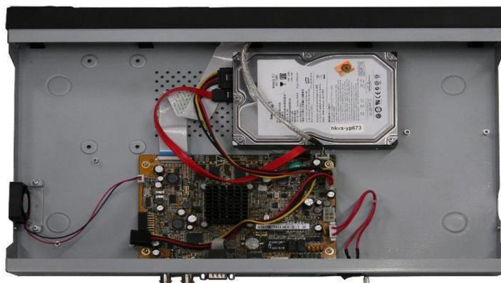
Figura 2-9 Fijar el Disco Duro
