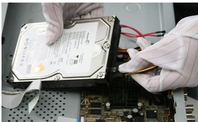
Figura 2-8 Conectar el Cable de Alimentación
