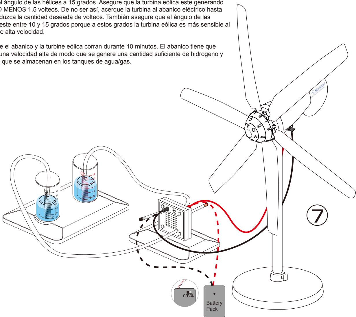
Si el viento que se produce es bastante el sistema va a comenzar a trabajar y producir hidrógeno al igual que oxígeno en los cilindros respectivos. Cuando aparezcan burbujas en la superficie del cilindro donde se almacena el hidrógeno el ciclo está completo. Desconecte la pila de combustible reversible de la turbina eólica.
