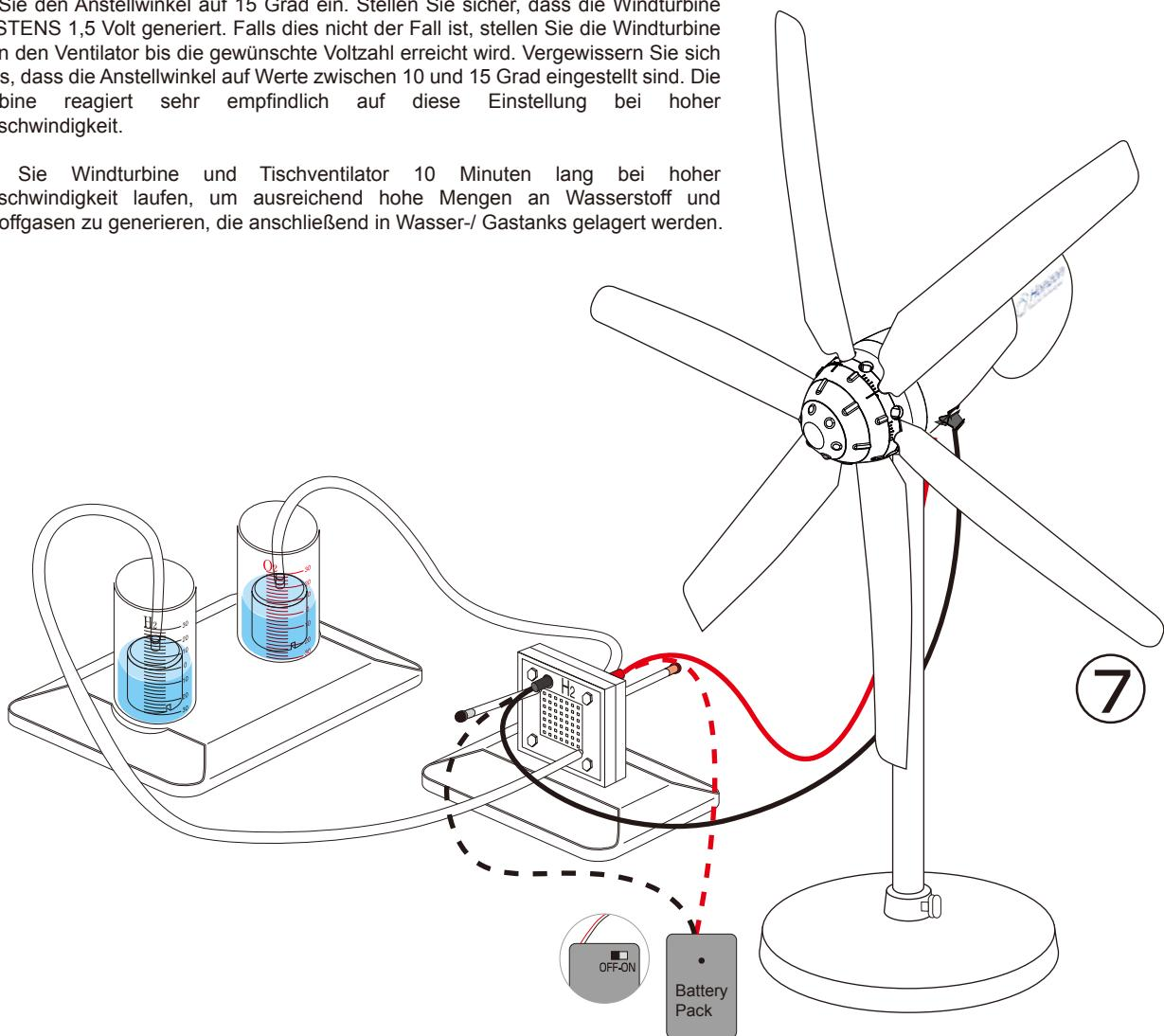
Wenn der Wind ausreichend ist, wird das System damit beginnen, Wasserstoff und Sauerstoff zu produzieren, die in den entsprechenden Zylindern gelagert werden. Wenn sich in den Wasserstoff-Zylindern Blasen zeigen, dann ist der Zyklus vollständig. Unterbrechen Sie den Anschluss der reversiblen Brennstoffzelle von der Windturbine.
