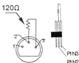
Se recomienda una terminación si el cable DMX debe cubrir una gran distancia o si se usa en un medio ambiente con mucho ruido eléctrico (ej. una discoteca). La terminación impide que el ruido eléctrico corrompa la señal de control numérico. La terminación DMX no es más que un conector XLR con una resistencia de  $120\Omega$  de polo 2 a polo 3. Este conector XLR está conectado a la salida XLR del último aparato de la serie. Véase la figura a la izquierda.
