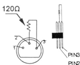
Een DMX terminator is aanbevolen als de DMX-kabel vrij lang is of wordt gebruikt in een omgeving met veel elektrische ruis (bv. een discotheek). De terminator voorkomt corruptie van het digitale controlesignaal door elektrische ruis. De DMX terminator is niets meer dan een XLR-stekker met een weerstand van 120  $\Omega$  van pin 2 naar 3. Deze XLR-stekker wordt dan aangesloten op de XLR-uitgang van het laatste toestel in de reeks. Zie de illustraties links.
