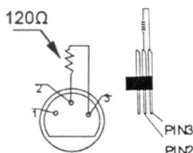
Ein DMX-Abschlusswiderstand empfehlenswert für Installationen, bei denen das DMX-Kabel lang ist oder in einer Umgebung mit vielem elektrischem Rauschen (z.B. Diskos) . Der Abschlusswiderstand verhindert Störung des digitalen Steuersignals durch elektrisches Rauschen. Der DMX-Abschlusswiderstand ist nur eine XLR-Buchse mit einem 120Ω Widerstand zwischen 2 und 3, die den XLR-Ausgang des letzten Geräts in der Kette angeschlossen wird. Siehe Abbildung links.
