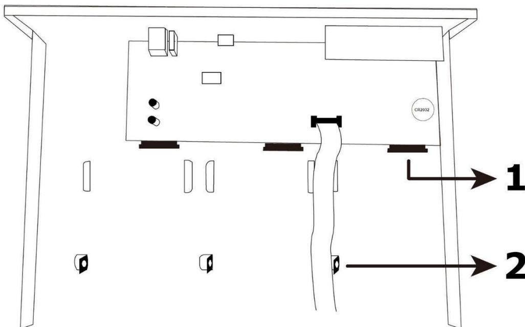
2. Consiga un disco duro compatible. Con la placa de circuito impreso orientada hacia abajo, introduzca el disco duro en uno de los conectores de disco duro.
