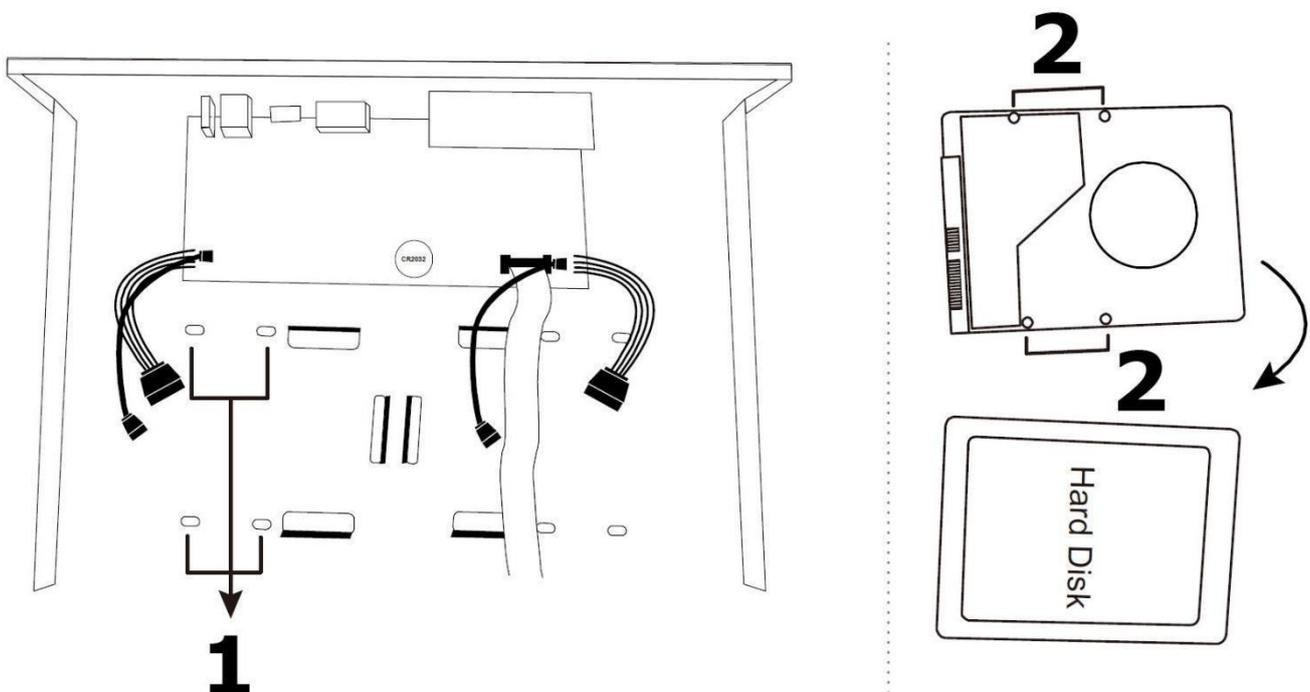
4. Schließen Sie das Datenbus- und das Stromversorgungskabel für die Festplatte an.
