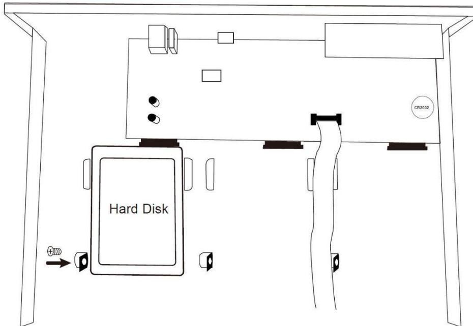
4. Befestigen Sie die obere Abdeckung wieder und schrauben Sie die Schrauben fest.
