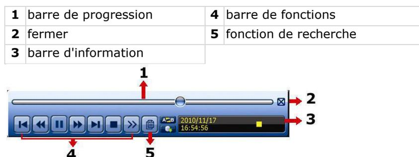
**Note :** Il faut qu'il y ait au moins 8192 images enregistrées pour que la lecture fonctionne correctement. Sinon, l'appareil arrêtera la lecture. Par exemple, si l'IPS est réglé sur 30, la durée enregistrée doit être d'au moins 273 secondes (8192 images/30 IPS) pour que la lecture fonctionne correctement.
