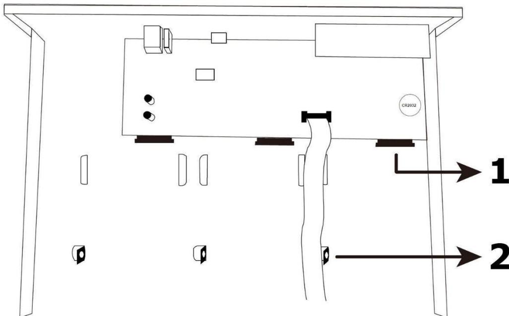
2. Nehmen Sie eine kompatible Festplatte. Mit der Leiterplattenseite nach untenweisend, schließen Sie die Festplatte an einen der Festplattenanschlüsse an.
