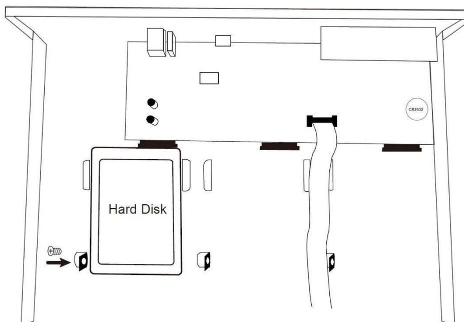
4. Volte a colocar a tampa no devido lugar e aperte os parafusos.
