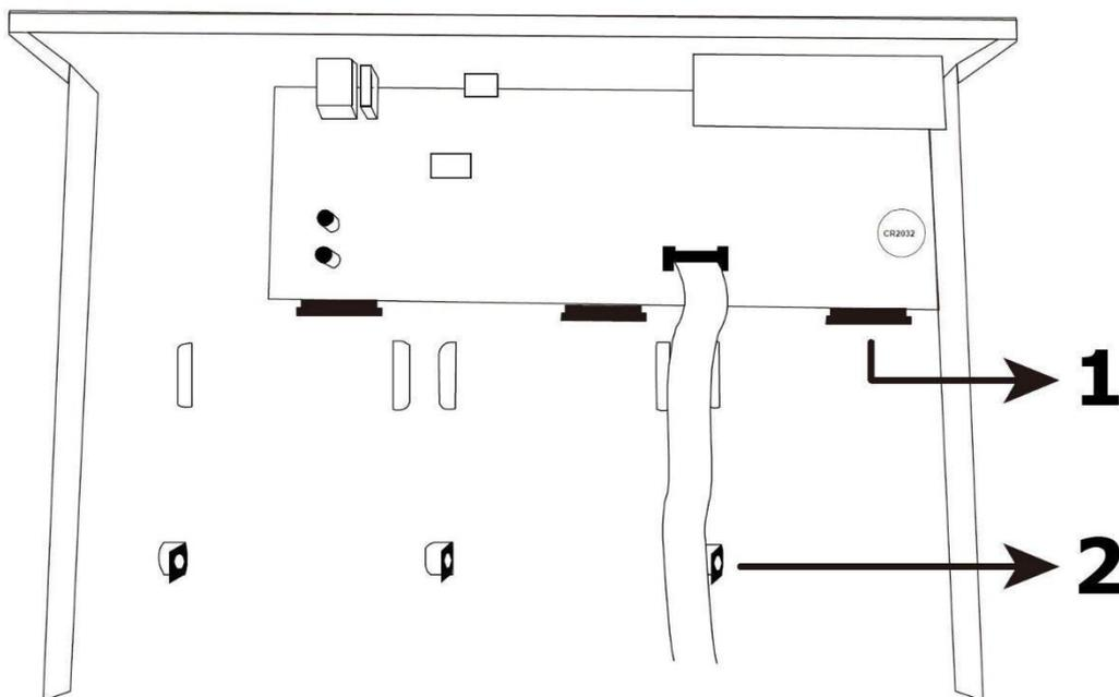
2. Escolha um disco rígido compatível. Com o lado PCB virado para baixo, introduza o disco rígido num dos conectores de disco rígido.
