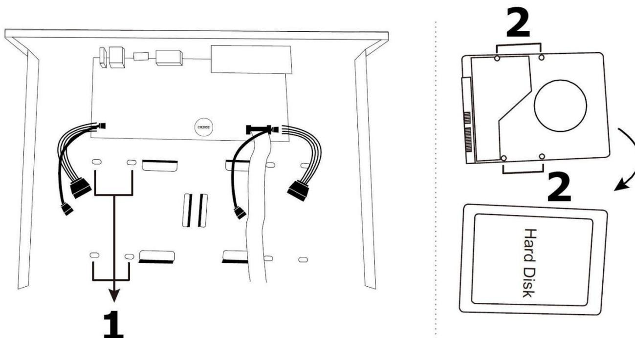
4. Conecte o barramento de dados e o cabo de alimentação para o disco rígido.
