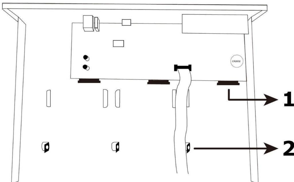
2. Utiliser un disque dur compatible. Avec le côté PCB vers le bas, insérer le disque dur dans un des connecteurs du disque dur.
