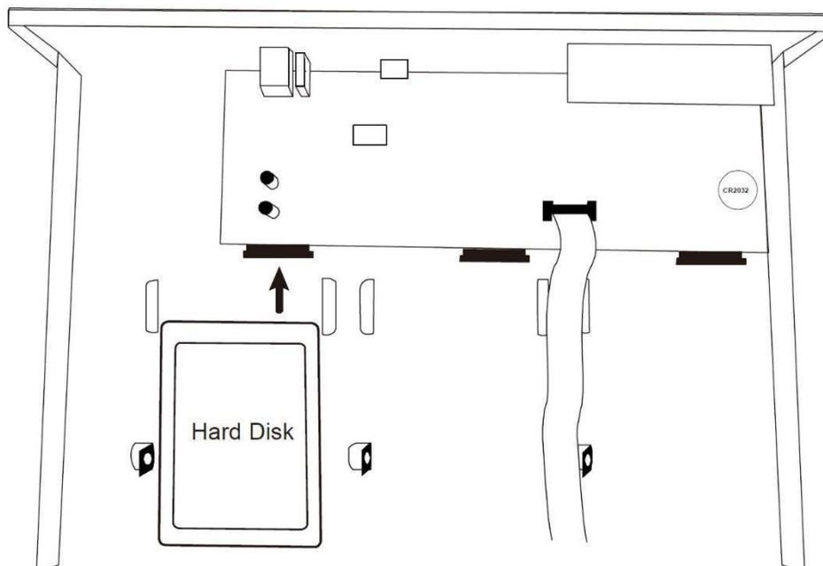
3. Befestigen Sie die Festplatte mit der Schraube an der Halterung.
