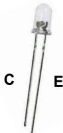
Un fototransistor es un transistor capaz de detectar los niveles de luz y cambiar la corriente según el nivel de luz que recibe. Es posible utilizarlo a light switch in electrical circuits.
