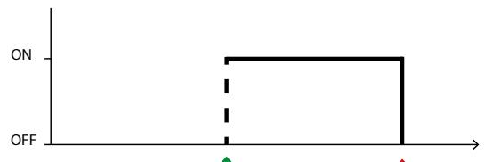
Soit en activant l'impulsion lorsque le relais est en position ON. Le relais reste en position ON pendant la durée réglée.
