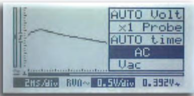
Par défaut, votre oscilloscope est réglé automatiquement pour démarrer en mode 'DC coupling' (couplage CC). Ajustez en 'AC coupling' (couplage CA, consultez le mode d'emploi pour des instructions).
