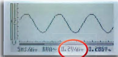
Ainsi, vous pouvez continuer ce processus jusqu'à ce que le RV1 soit roté complètement dans le sens d'horloge. Dans ce cas, nous mesurons la tension d'entrée à pleine puissance que nous avons également mesurée dans l'expérience 1.
