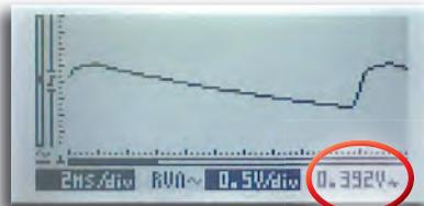
Regardez l'image ci-après et l'écran de votre oscilloscope. Vous verrez une onde en forme de dent de scie. C'est l'ondulation qui se trouve au-dessus de votre tension continue. Durant le front montant, le condensateur se recharge, durant le front descendant, plus de courant est absorbé par le circuit, plus l'ondulation sera élevée; puisque le condensateur se décharge et n'arrive pas à stabiliser la sortie comme lors d'une charge plus faible.
