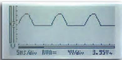
Déplacez maintenant la position de l'interrupteur de redressement simple alternance en position double alternance et regardez ce qu'il se passe.
