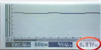
Maintenant, l'oscilloscope affiche la tension continue mesurée en bas à droite
