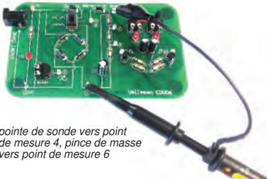
pointe de sonde vers point de mesure 4, pince de masse vers point de mesure 6
