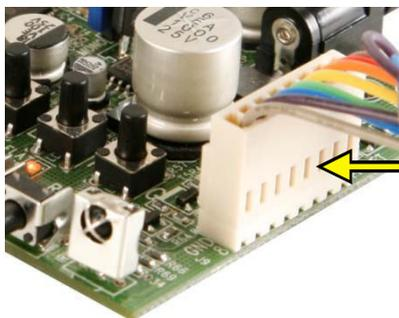
Il est possible de connecter jusqu'à 7 boutons programmables (ont la même fonction que les boutons incorporés)
