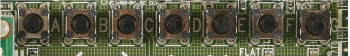
Todos los pulsadores preajustados se conectan automáticamente a un fichero de la tarjeta SD. Para hacer esto, es necesario que los ficheros de la tarjeta SD tengan un nombre: A, B, C, D y E. Cada fichero contiene sus propios ficheros.
