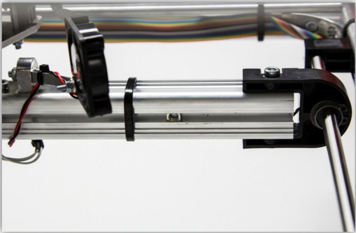
Verwenden Sie einen Sechskantschlüssel, um die Vierkantmutter in die Position der vorhin entfernten Schraube zu bringen.
