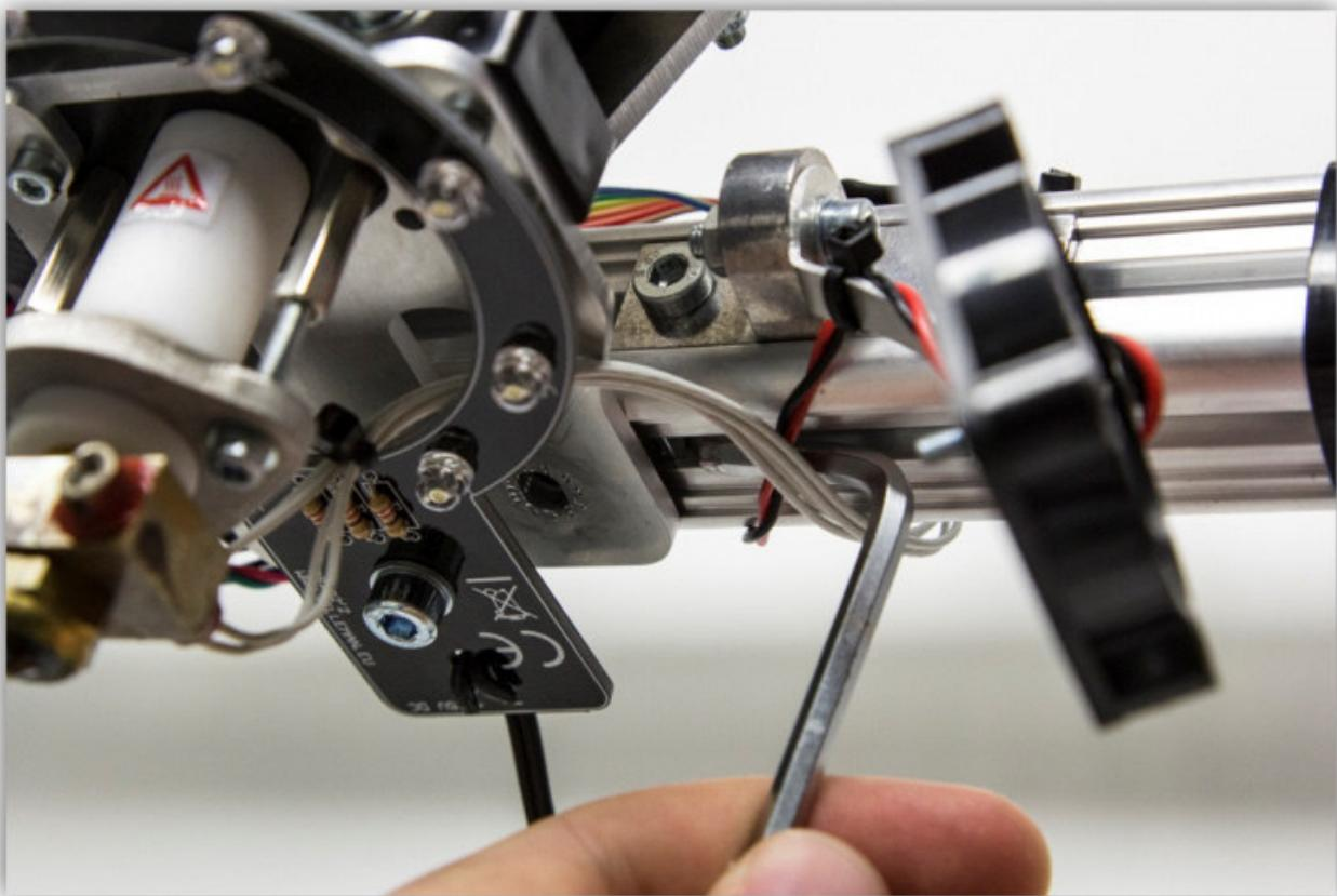
Befestigen Sie die vorhin entfernte Schraube wieder am K8200.
