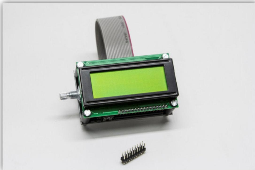
Befestigen Sie den 18-pol. Anschluss an der Hauptplatine des K8200 (löten).
