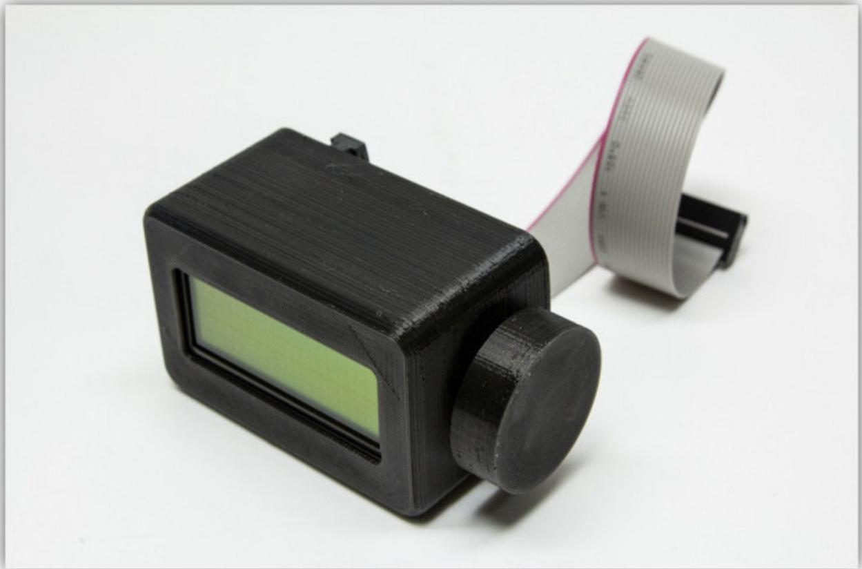
Schieben Sie das Modul in die Rille des rechten Aluminiumprofils. Lockern Sie die Spulhalterung und entfernen Sie einige Kabelbinder. Wenn nötig, schmirgeln Sie den Clip auf der Rückseite des Gehäuses ein bisschen, damit die Spulhalterung einfacher schiebt.
