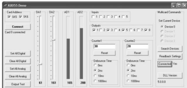
Testez les sorties analogiques avec le bouton 'set all analog' et ajustez la tension de sortie avec DA1 & DA2. Testez le compteur avec les boutons-poussoirs Inp1 et Inp2 : les compteurs respectifs continuent le comptage chaque fois que le bouton est pressé. Vous réglez le temps de réponse du compteur (0ms - 2ms - 10ms - 1000ms) avec le réglage d'élimination du rebondissement.
