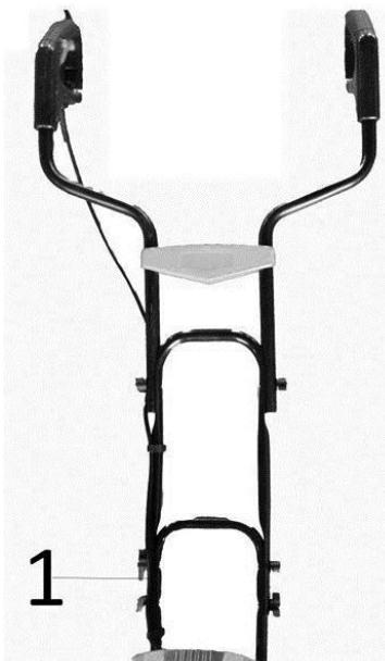
1. Monter le cadre supérieur avec les poignées sur le cadre inférieur.
