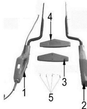
1. Monter les traverses supérieure et inférieure sur les poignées gauche et droite.
